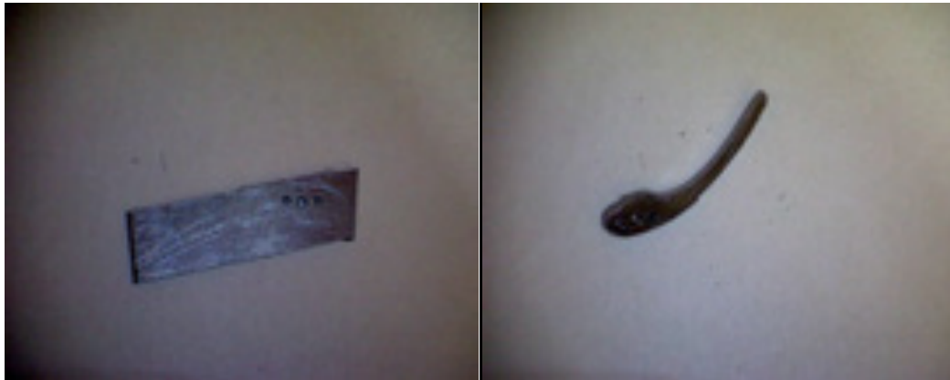
Abb. 16 Stahlblech auswählen, befestigen und anreißen. Bohrungen setzen und anschließend aussägen.
