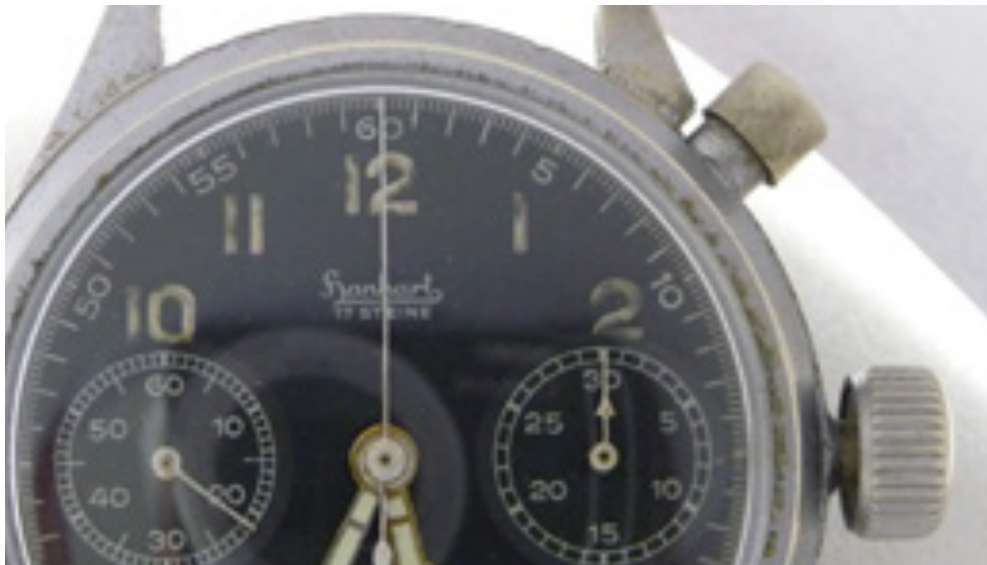
Abb.12 Durch Feuchtigkeit angegriffenes Zifferblatt. Die Aufzugskrone hat zuviel Abstand zum Gehäuse.
