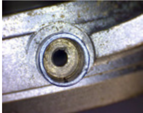
Abb.14 Demontierter Drücker, mit verhärteter Kautschukdichtung und ausgefressener Drückerbohrung.
