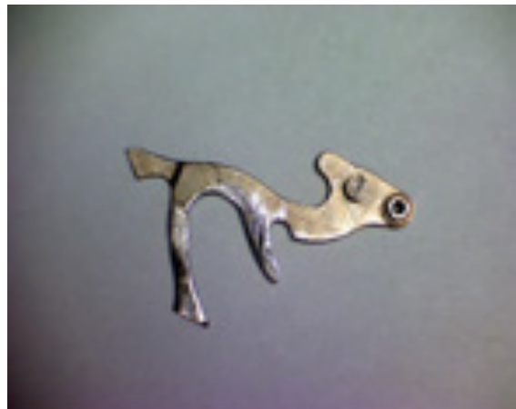
Abb.4 Herzhebel (Unterseite ist verschliffen).
