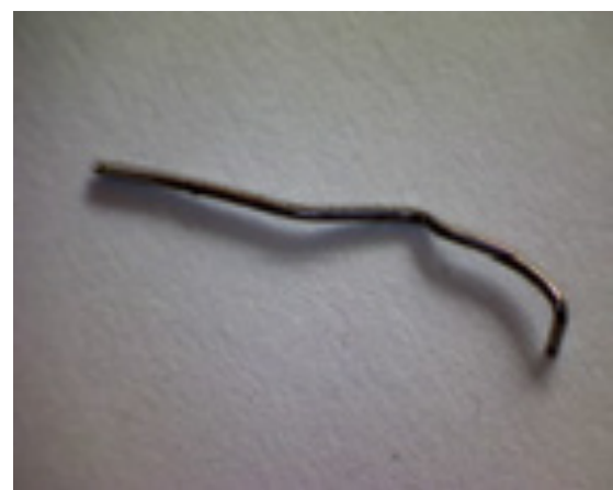
Abb. 6 Aus Draht gebogene Herzhebelfeder
