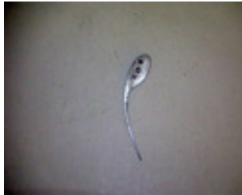
Abb. 17 + 18 Feder zu gefeilt und geschliffen. Zwei Zentrierfüße montiert.
